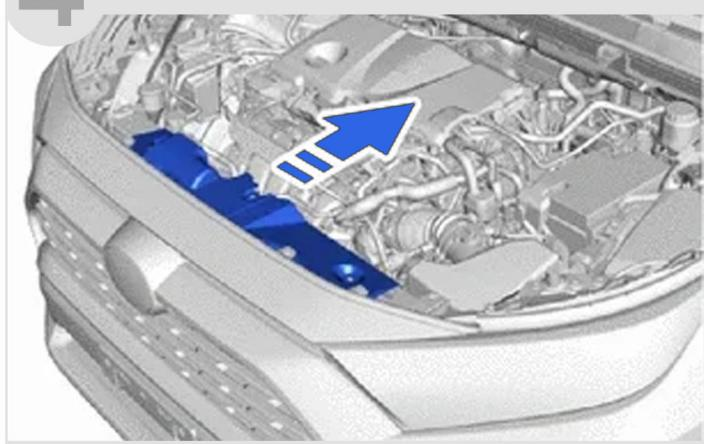
5 Отверните **2 винта**, нажмите на фиксатор
