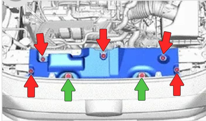
4 Снимите **верхнюю пластину радиаторов**.
