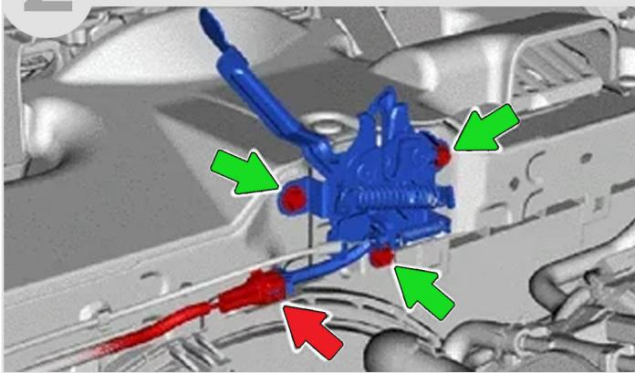
3 Освободите **5 фиксаторов**, отверните **2 болта**.
